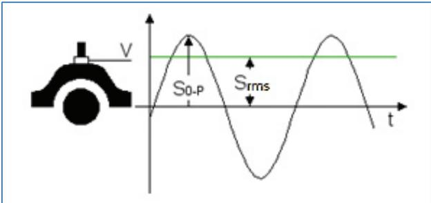
Figure 16. Bearing vibration  $S_{rms}$ : RMS.
