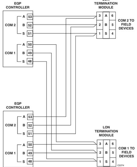
NOTE: LON TERMINATION JUMPERS P25 AND P26 (SEE FIGURE 3-12) MUST BE IN POSITION 2 AND 3 FOR REDUNDANT CONFIGURATION (ON BOTH CONTROLLERS).
