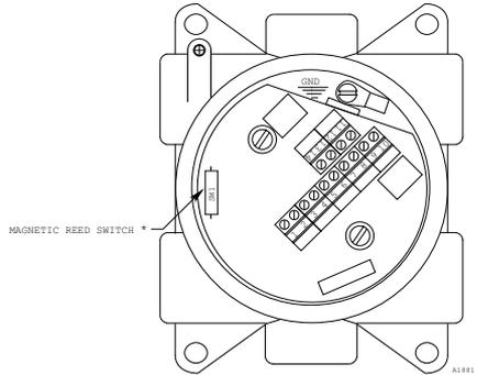
\* TO ACTIVATE THE MAGNETIC REED SWITCH, HOLD THE CALIBRATION MAGNET AGAINST THE SIDE OF THE ENCLOSURE AT THE LOCATION OF THE REED SWITCH, APPROXIMATELY ONE INCH ABOVE THE MOUNTING SURFACE.
